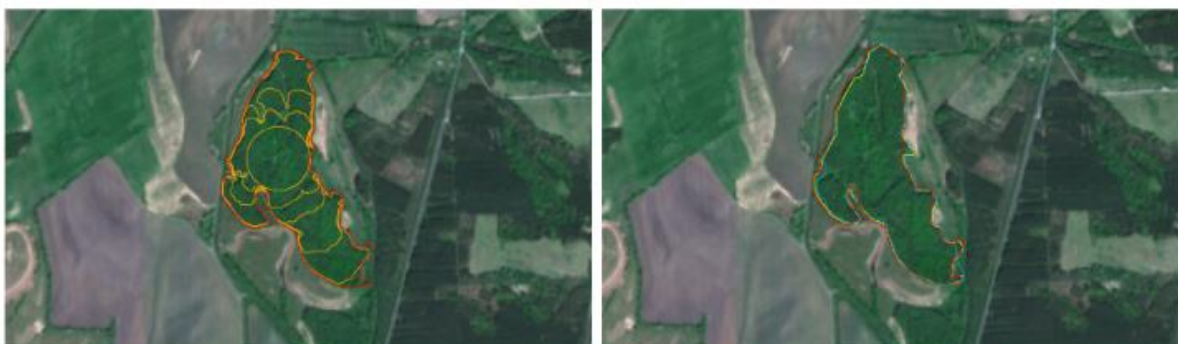
Rycina 18. Po lewej: ewolucja krzywej segmentacji od koła początkowego do stanu końcowego. Po prawej: końcowa automatyczna segmentacja (czerwona) wraz z wynikiem segmentacji półautomatycznej (żółty) i ślad GPS (jasnoniebieski) (Mikula i in., 2021a)
