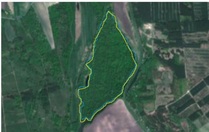
Rycina 17. Półautomatyczna segmentacja (żółty) i ślad GPS (jasnoniebieski). Maksymalna odległość Hausdorffa wynosi w tym przypadku 62,1 m, a średnia odległość Hausdorffa wynosi 14,0 m, co oznacza, że uzyskano dokładność odpowiadającą 1 pikselowi zobrażenia satelitarnego (Mikula i in., 2021b)
